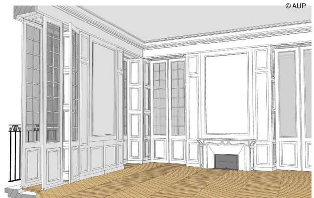
Pose d'une double fenêtre, reprenant les caractéristiques architecturales de la menuiserie existante, Modélisation ©AUP
