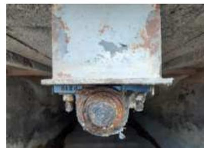
→ **Changement des « u » partie haute convoyeurs – pièce d'usure**
